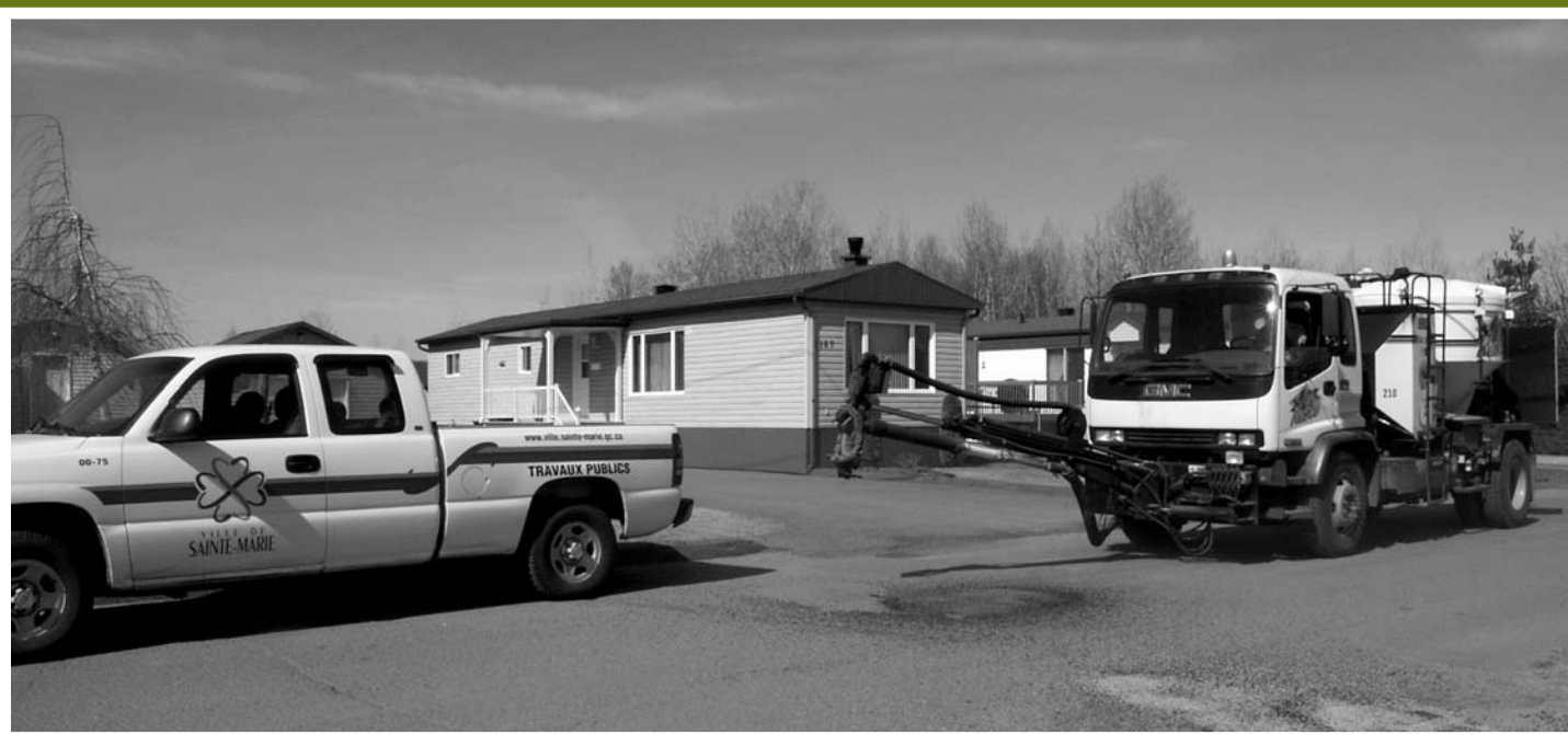
Le camion spécialisé de la compagnie Nasco permet une réparation rapide et durable des nids-de-poule.
